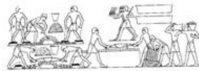
Abb. 2 Arbeit in einer Metallgießerei. Arbeiter bringen Rohmetall (rechts), treten auf Blasebälge, um Luft ins Feuer zu blasen (links oben), darunter wird Metall geschmolzen.
